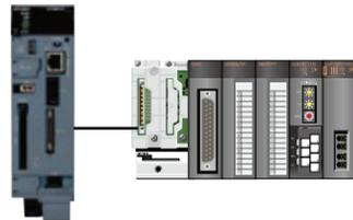
无限的Q170MCP! 当需要增加或改变系统功能时，无论是 I/O 模块、A/D 转换模块、温度控制模块还是其他的如网络通讯模块等，都可方便快捷地添加到系统中，无需重新设计系统
